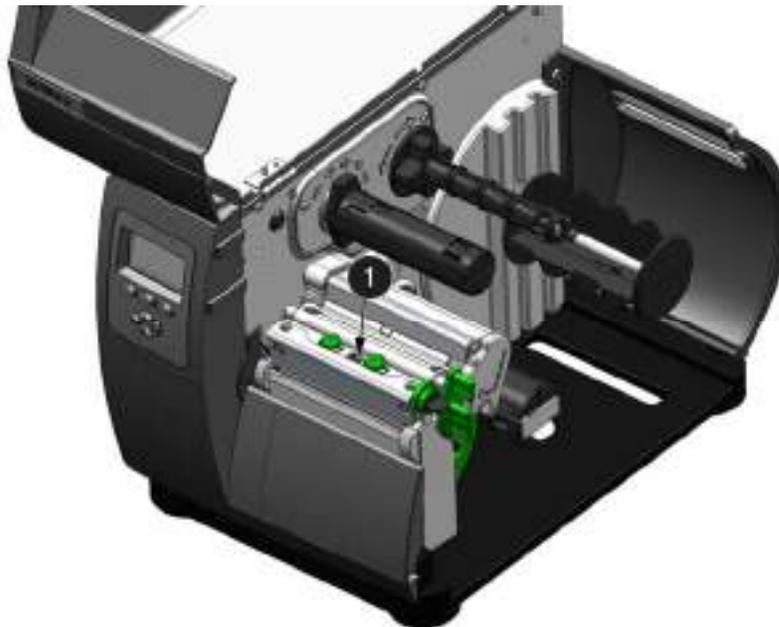
1 Tornillo de montaje de cabezal de impresión
